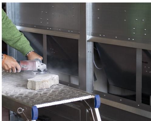
Il sistema di captazione dinamico è dotato di paratie frontali ad apertura/chiusura automatica, con importanti vantaggi operativi :
