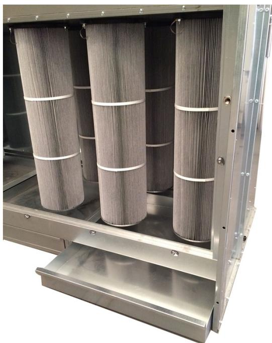
Le cartucce filtranti integrate nel sistema di aspirazione hanno un'efficienza di filtrazione del 99% come richiesto dalle normative e sono costruite in tessuto filtrante in poliestere antistatico con rivestimento in teflon, garanzia di durata ed efficienza con le polveri da lavorazione a secco di inerti, marmi e pietre.
